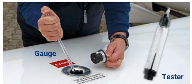
❹ Mit einem **Fuel Gauge**, auch Fuel Finger oder Peilstab genannt, kannst du den genauen Tankinhalt schnell und einfach ermitteln. Die Überprüfung des Kraftstoffes auf Wasser und Verschmutzung (Drainen) erfolgt hingegen mit einem **Fuel Tester** und sollte vor dem Flug sowie nach jeder Betankung erfolgen.
